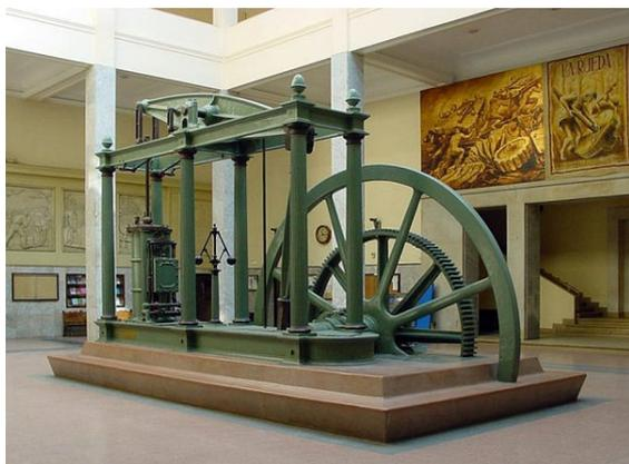
*Uma máquina a vapor de Watt. O motor a vapor, abastecido primeiramente com carvão, impulsionou a Revolução Industrial no Reino Unido.*<sup>[36]</sup>
